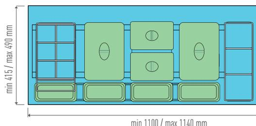
Profondeur minimum 415 mm après recoupe / maxi 490 mm
