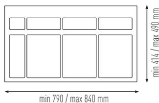
Profondeur min. 414 mm après recoupe / maxi 490 mm
