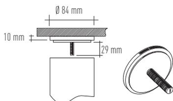
Système de fixation par perçage pour pieds Ø 80 mm
