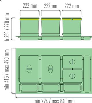
Profondeur min. 415 mm après recoupe / maxi 490 mm
