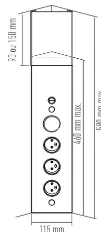
Le mini interrupteur sert à commander uniquement la LED (0,2 W)
