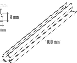
Avec système de fixation par adhésif. Longueur 1 m
